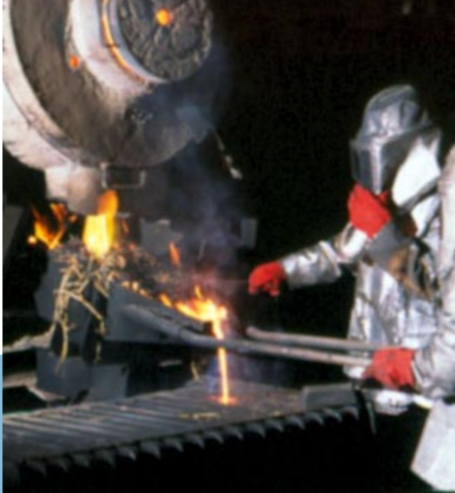
Penuangan emas menjadi bullion di Tambang Emas Pongkor.
