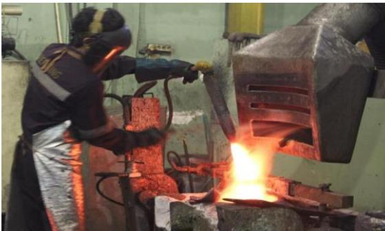
Pada tahap klorinasi ini dilakukan pelelehan terhadap *anode* dari peleburan di *induction furnace* dan langsung diinjeksikan dengan gas klorin setelah material sudah meleleh.
